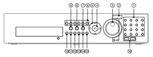
①カメラボタン ②LED ③ジョグダイヤル ④エンターボタン ⑤矢印ボタン ⑥再生ボタン ⑦カメラ操作ボタン ⑧アラームボタン ⑨緊急録画ボタン ⑩一時停止ボタン ⑪ブックマークボタン ⑫拡大ボタン ⑬モニタボタン ⑭画面分割ボタン ⑮メニューボタン ⑯USB コネクタ
